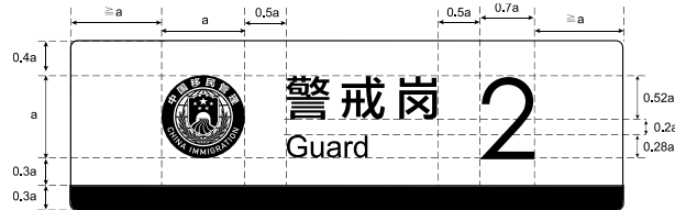
图10 办案区、询问室、等候室、报检室、警戒岗（普通）和监护岗（普通）6个设施标志规格
