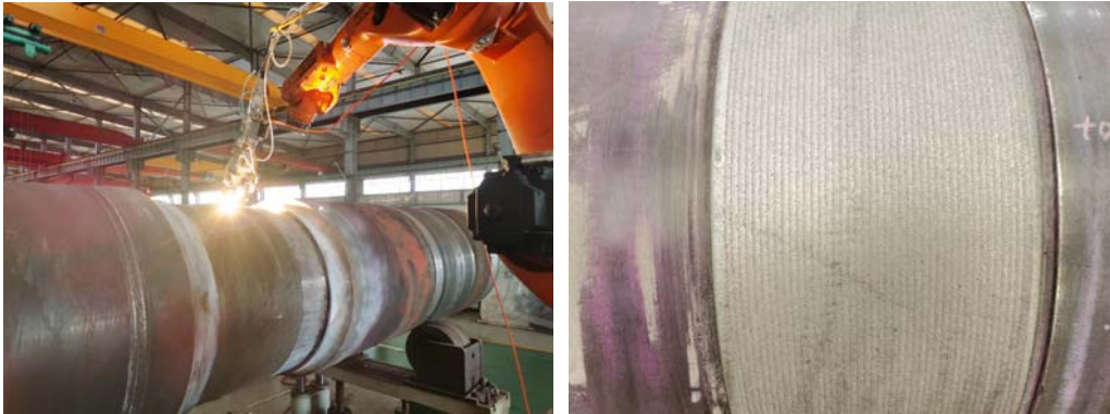
图2.1-2.2 中间接轴再制造过程
